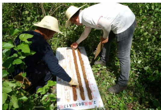
图七 采集勘探土样
