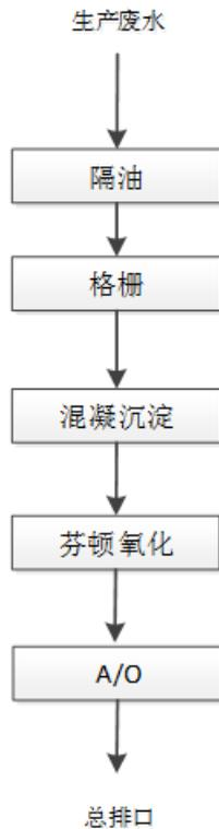
图7.2-1 废水处理流程图
