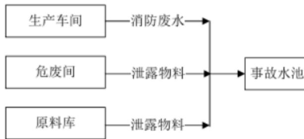
图 6.8-4 事故废水导排系统示意图
