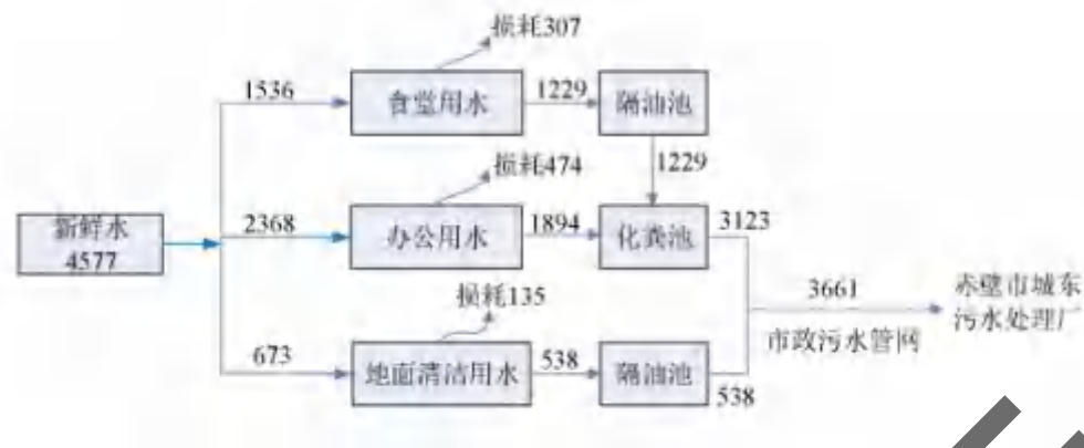
图 3.3-8 扩建项目水平衡图 (m³/a)
